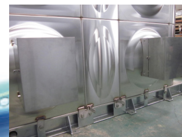
通常は接続口に扉をしておく
